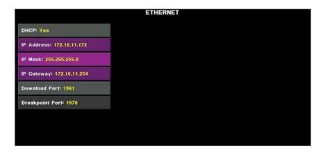
Le DHCP des jeux AGS doit toujours être inaccessible (mauve). Mettre la DIP switch 2 a ON.
